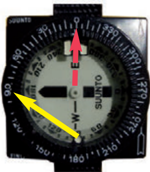
Figura 1.13 Brújula con la rosa de los vientos en la corona invertida horizontalmente. El rumbo de la línea de fe sería el 90°
