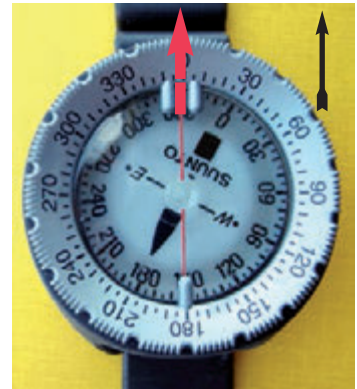
Figura 1.14 Brújula con los rumbos dibujados en la corona correctamente
