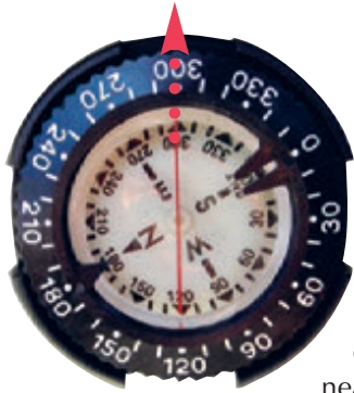
Figura 1.11 La línea de fe es la línea roja
