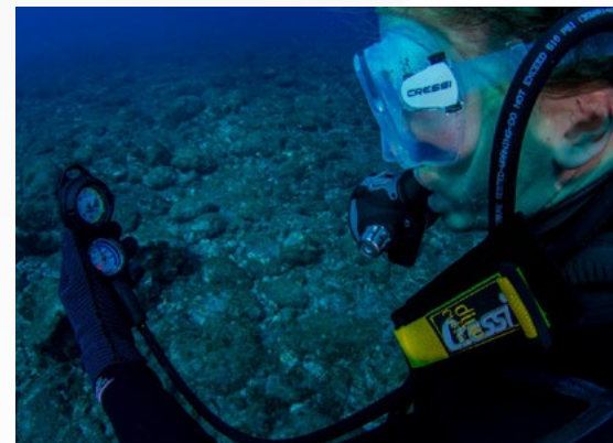
Con el manómetro podemos saber en todo momento la presión de la botella.
